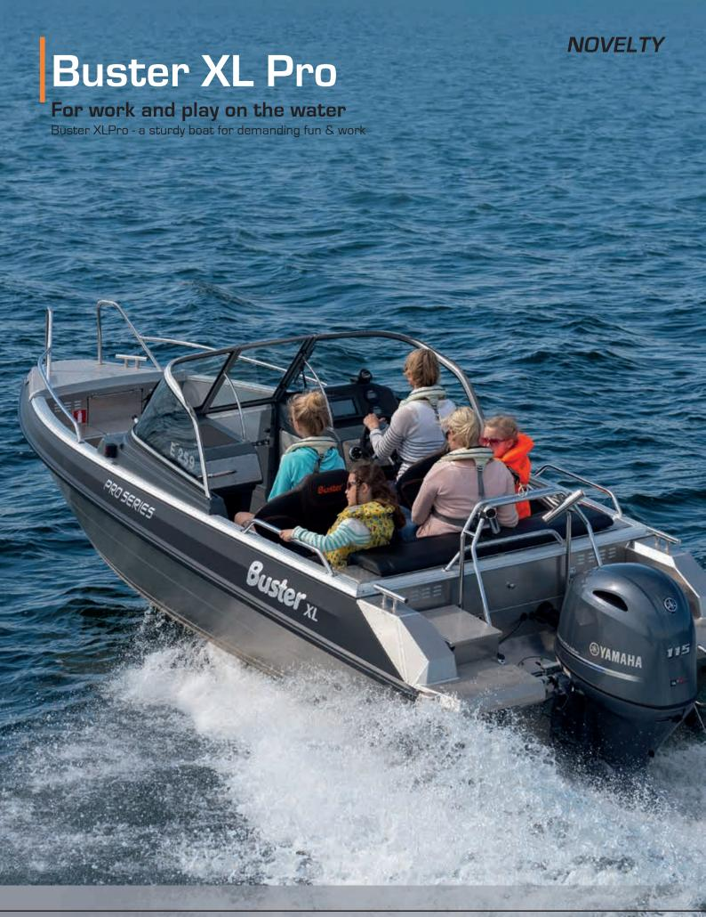
LENGTH 5,94 m / WIDTH 2,17 m / ENGINE POWER RANGE 70-115 hp / SEATING CAPACITY 7
